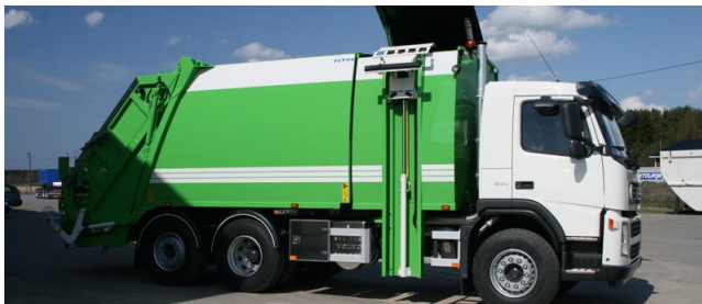
Śmieciarka dwukomorowa do selektywnej zbiórki odpadów komunalnych
