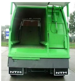
Śmieciarka dwukomorowa do selektywnej zbiórki odpadów komunalnych
